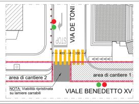
MICRO FASE D.12: Impermeabilizzazioni e ricopertura con materiale di scavo Dal 14.05.2022 al 02.06.2022
