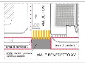
MICRO FASE D.11: Realizzazione solaio in una parte di attraversamento su Via de Toni Dal 10.05.2022 al 13.05.2022
