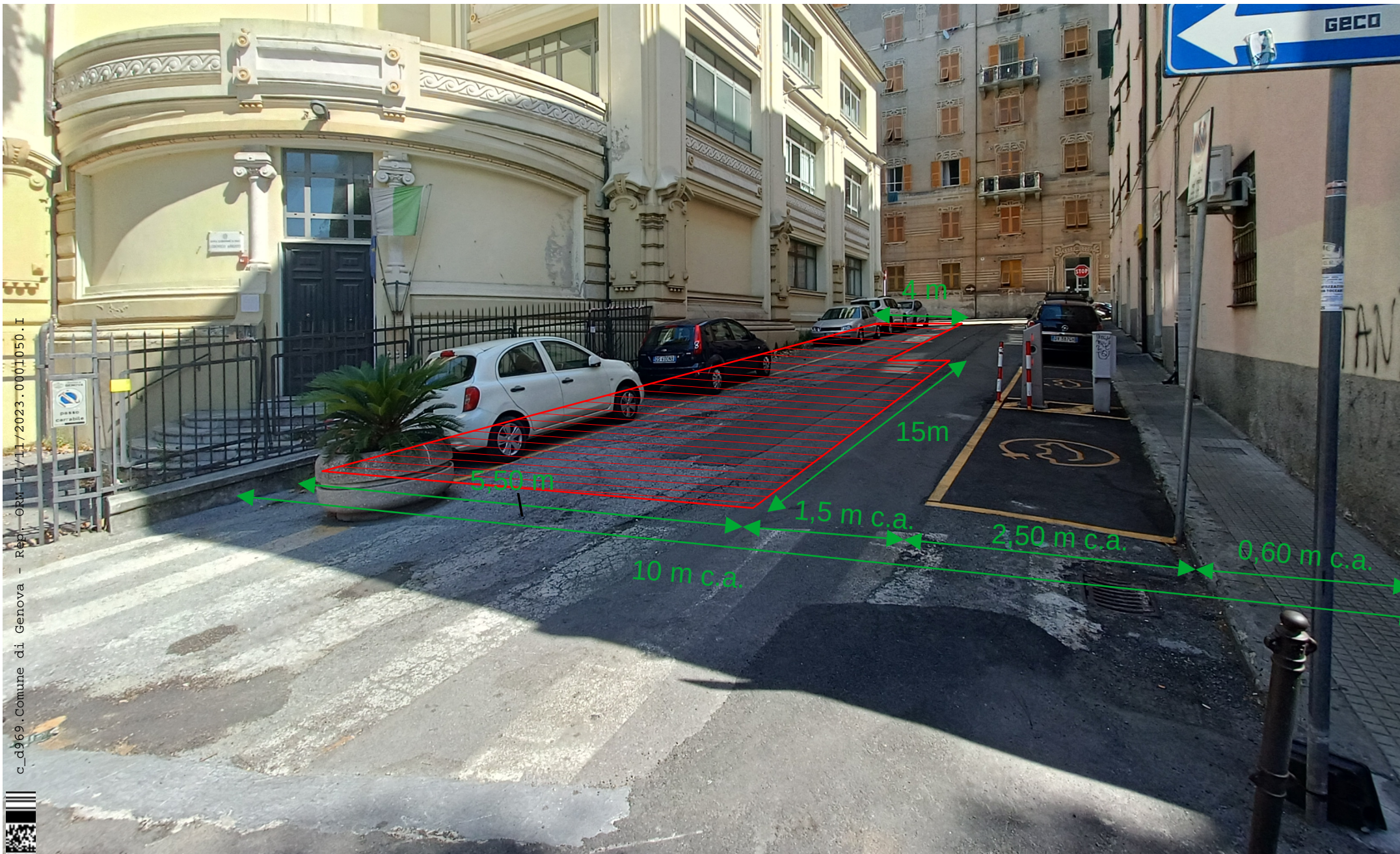
Richiesta ordinanza per occupazione suolo ai fini dell'ingrandimento dell'area di cantiere. Dimensioni area di cantiere totale (già autorizzata + nuova istanza): 5,50x15m + 4,00x13,5m
