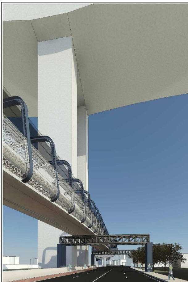
Figura 3. Simulazione dei cavalletti con travatura reticolare
