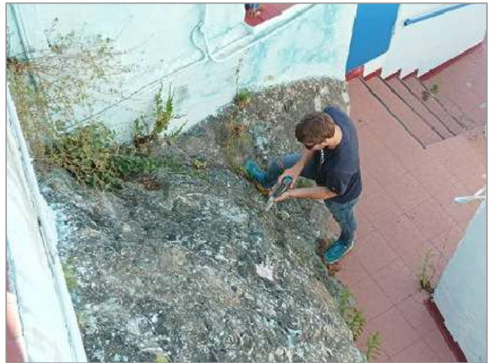
Foto 16: prove con sclerometro Stazione 2.
