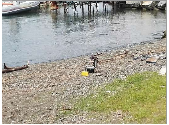
Foto 10: prova sismica passiva S_p (10).
