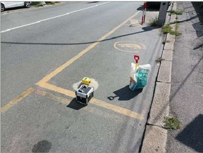
Foto 11: prova sismica passiva S_p (11).
