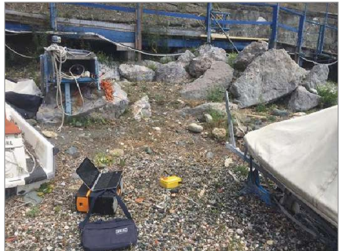
Foto 8: prova sismica passiva S_p (8).
