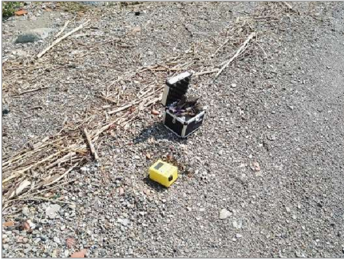
Foto 1: prova sismica passiva S_p (1).
