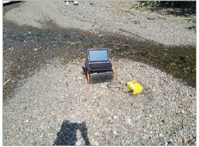
Foto 2: prova sismica passiva S_p (2).
