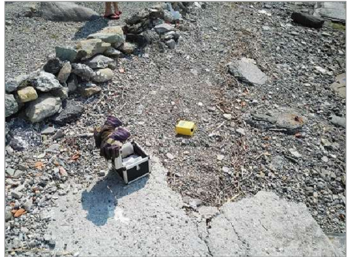
Foto 6: prova sismica passiva S_p (6).
