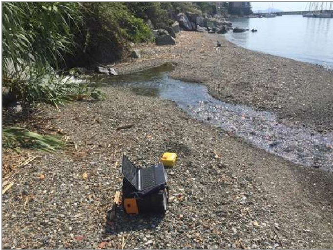
Foto 3: prova sismica passiva S_p (3).
