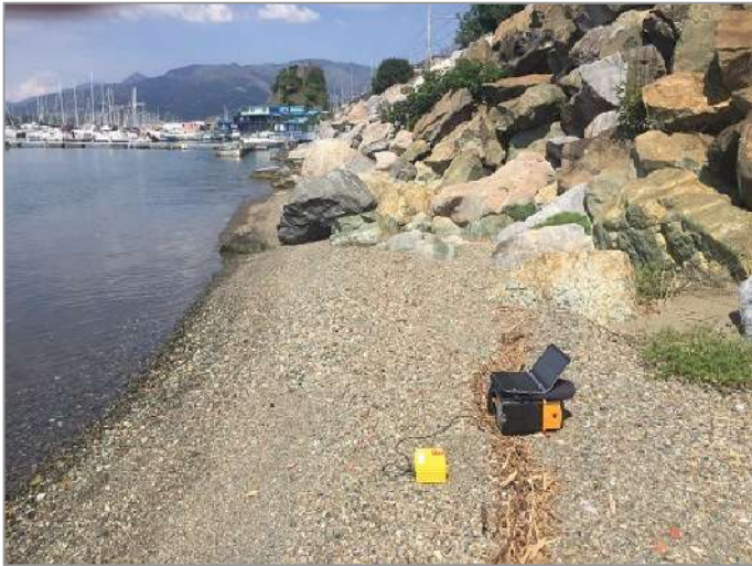
Foto 5: prova sismica passiva S_p (5).
