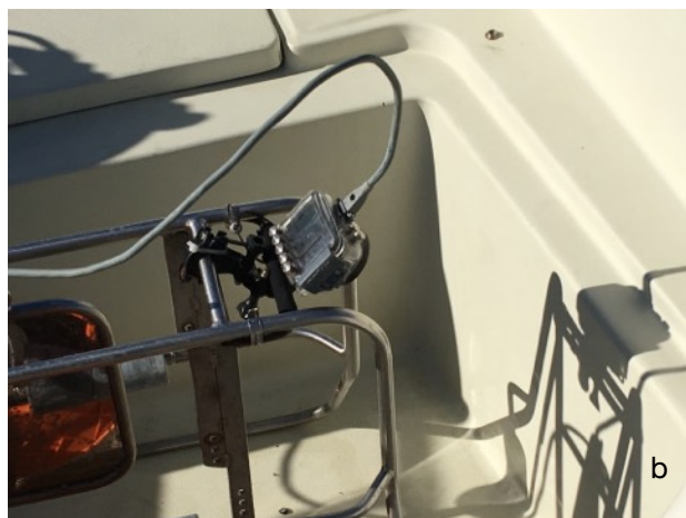
Fig. 3: le apparecchiature del sistema Tritone: (a) modulo per il posizionamento GPS, interfacciato con dispositivi portatili (tablet o smartphone); (b) slitta per telecamera full HD cablata che registra su microSD e invia le immagini in diretta ad un monitor a bordo.
