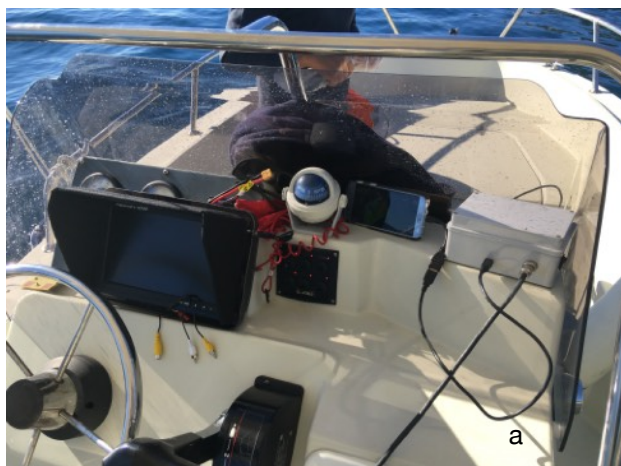
Fig. 3: le apparecchiature del sistema Tritone: (a) modulo per il posizionamento GPS, interfacciato con dispositivi portatili (tablet o smartphone); (b) slitta per telecamera full HD cablata che registra su microSD e invia le immagini in diretta ad un monitor a bordo.
