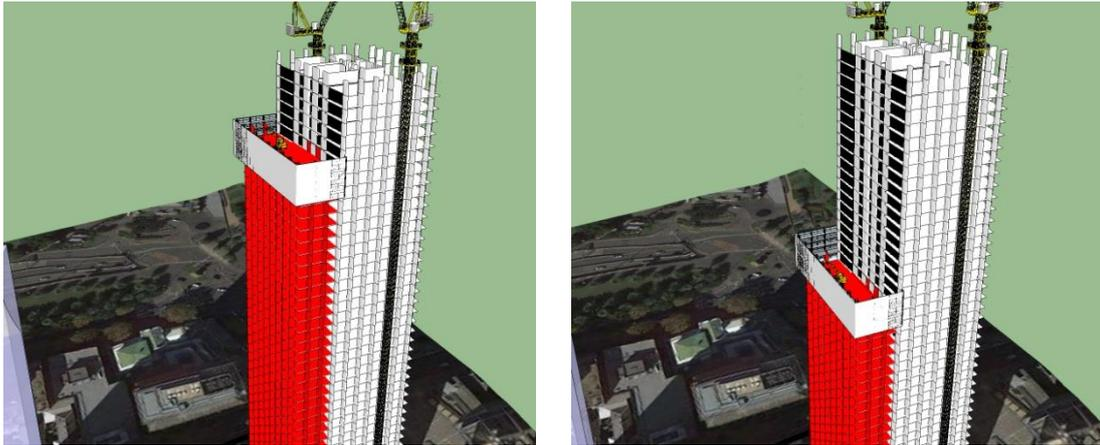
Abbassamento progressivo della demolizione e contestuale riposizionamento del ponteggio autodiscendente, che scorre su guide fissate alla struttura dell'edificio (esempio tratto da studio per una demolizione parziale)
