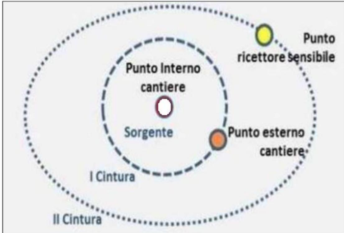
Figura 4 Rappresentazione schematica delle fasce/cinture di monitoraggio
