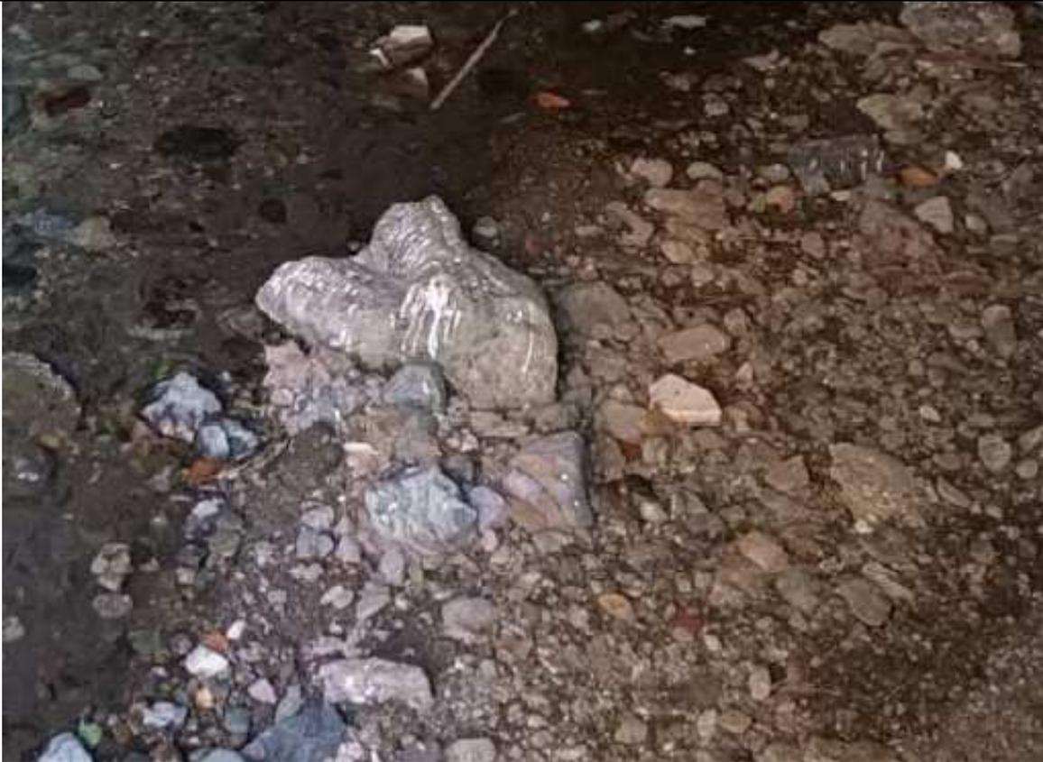
Figura 62 – RIO GRILLÈ – Imbocco della copertura – Dettaglio dei sedimenti grossolani che corazzano il fondo
