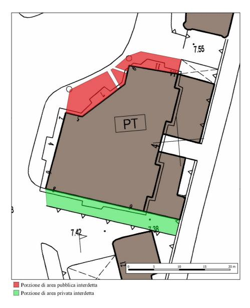
Figura 1: INDICAZIONE DI MASSIMA DELLE AREE ESTERNE SOGGETTE A TEMPORANEA INTERDIZIONE CON DIVIETO DI ACCESSO (grafica non in scala,
