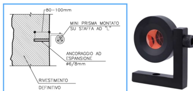
Figura 4.1: Mire ottiche per il monitoraggio delle opere di sostegno
