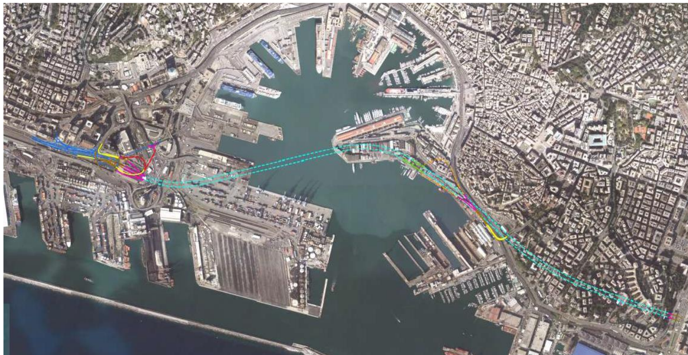
Figura 7 – Tracciato del Tunnel sub-portuale
