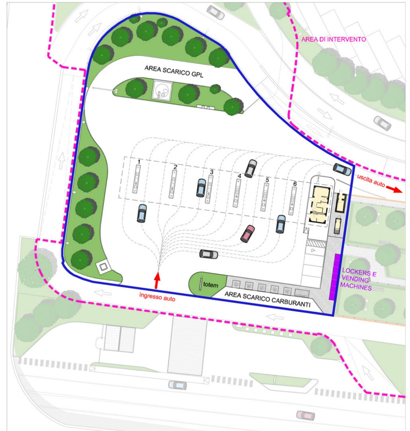
Schema planimetrico dell'Impianto di distribuzione carburanti di progetto
