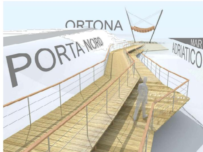
il percorso ciclabile ed il percorso pedonale sono separati da parapetto e dislivello di quota
